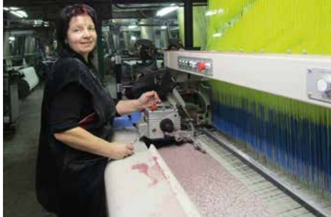
Пусконаладочные работы и освоение современного рапирного ткацкого станка
